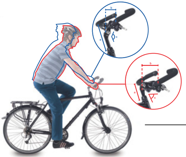
Illustration 60 : Position sur vélo de ville (en bleu) et sur vélo tout chemin (en rouge) avec modification de l'angle
