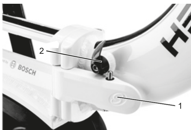
Illustration 87 : Levier de blocage du cadre fermé (1) et ouvert (2)
