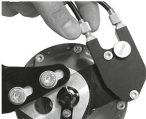
Illustration 104 : Sur les versions de moyeux ROHLOFF avec commande externe du changement de vitesse, le dispositif de réglage de la tension est situé sur le boîtier de câbles qui est placé sur le côté gauche.
