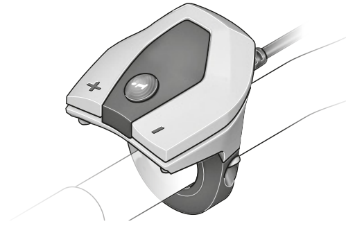
Illustration 29 : Vue d'ensemble de l'unité de commande
