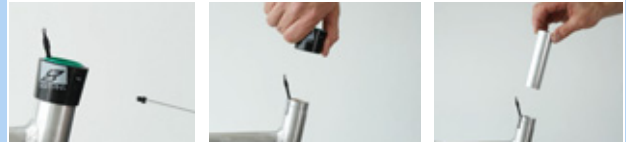
Illustration 153 : Démonter l'enveloppe extérieure et la douille de glissement
