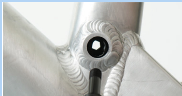
Illustration 171 : Trou de l'interface Postpin
