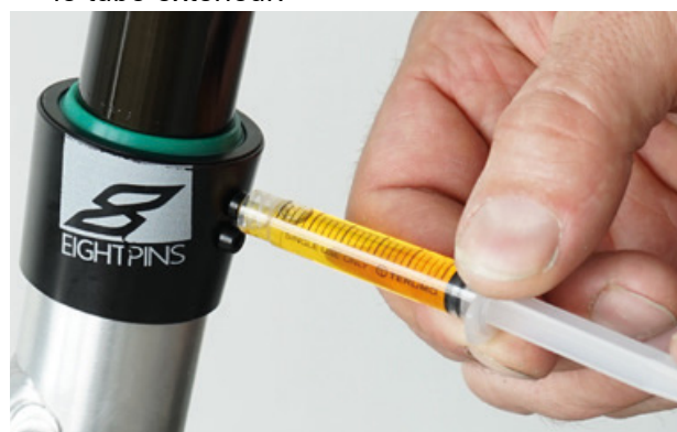
Illustration 96 : Lubrifier un tube de tige de selle
