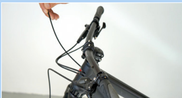
Illustration 170 : Accrocher le capuchon d'extrémité
