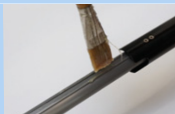
Illustration 165 : Appliquer de la graisse
