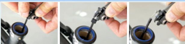
Illustration 152 : Retirer le câble Bowden
